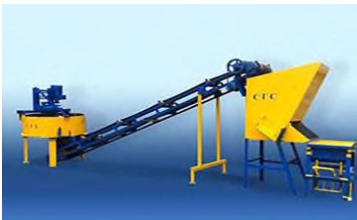
Установка для производства блоков.
